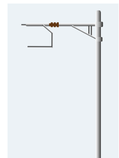
Fahrleitung, z.B. SBB 15 kV
