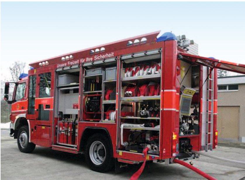
Tanklöschfahrzeug (TLF), z.B. 2'400 l
